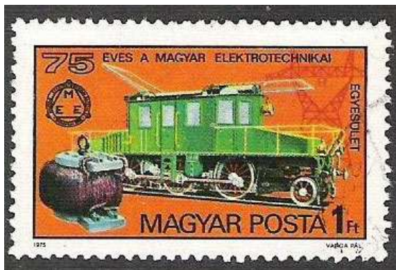
Fig. 4 – Francobollo ungherese dedicato ai 75 anni di elettrotecnica magiara ove è rappresentata una locomotiva trifase del gruppo E.360, caratterizzata dalla trasmissione a bielle e dai pantografi a rulli che equipaggiavano le prime produzioni della ditta ungherese Ganz. Questa locomotiva venne utilizzata sulla linea del Sempione tra Italia e Svizzera.
