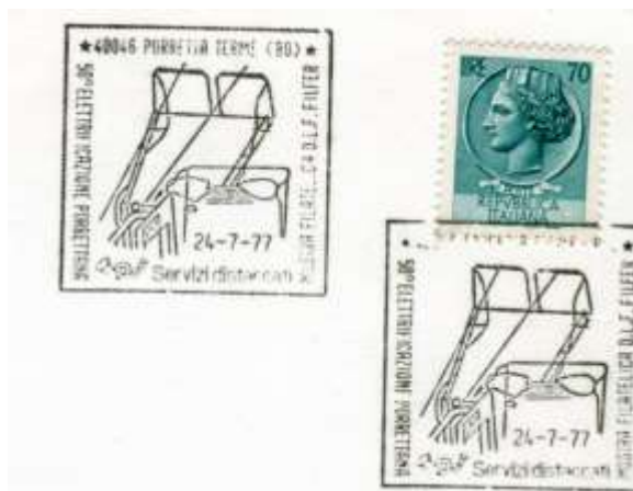
Fig. 5 – In questo annullo speciale, dedicato al 50° anniversario dell’elettrificazione della ferrovia Porrettana, è ben rappresentato un particolare del doppio strisciante di cui era dotato il pantografo trifase a stanga tipo Brown – Boveri, che ha equipaggiato la maggior parte delle locomotive trifase italiane. Questo tipo di pantografo è nato come evoluzione del sistema Ganz a rulli che venne applicato sulle prime locomotive di costruzione ungherese.
